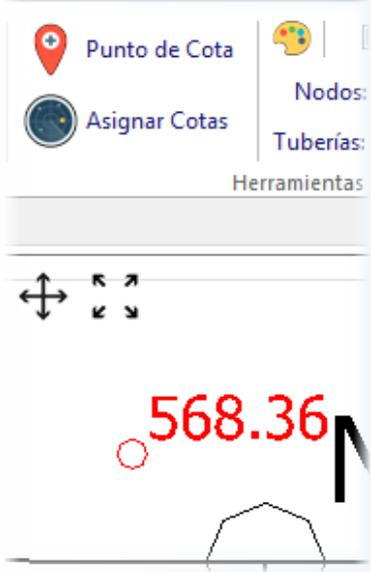
Creando en tu proyecto las referencias altimétricas, bien sea dibujándolas o importando desde archivos de dibujo o de MS Excel podrás, pulsando sólo un botón, obtener las elevaciones de terreno de nodos y de los perfiles de tuberías.
